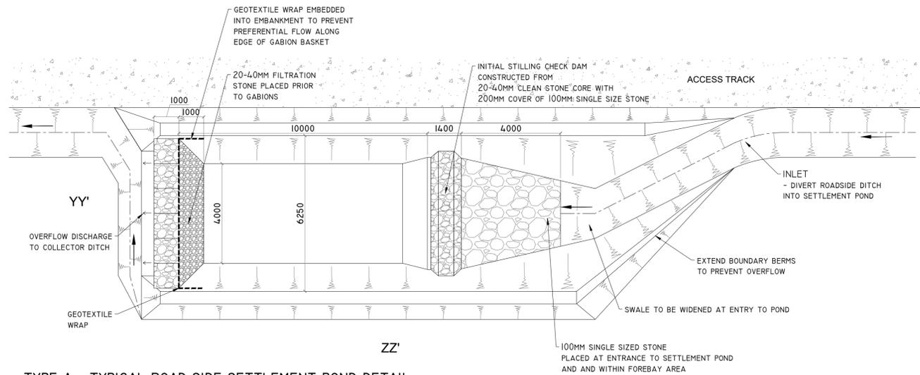
**TYPE A - TYPICAL ROAD SIDE SETTLEMENT POND DETAIL**
